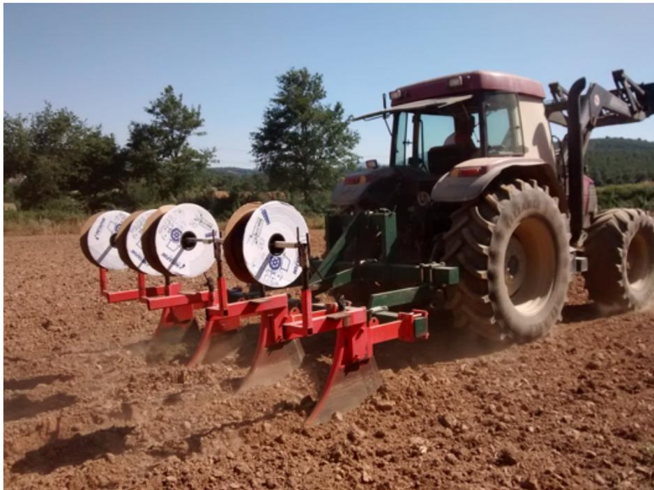
**Figura 16** – Particolare della messa in opera delle ali gocciolanti sotto-superficiali
